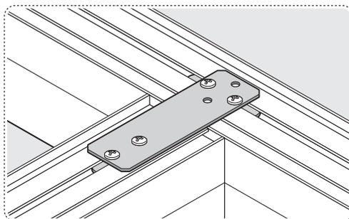
**2** Установить большую соединительную пластину так же, как в соединении под прямым углом
