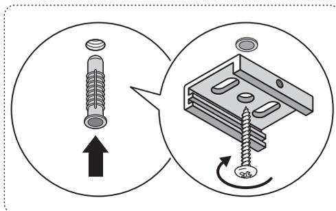
**2** Закрепить на поверхности потолка скобы крепления
