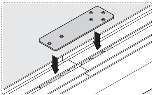
**2** Установить большую соединительную пластину
