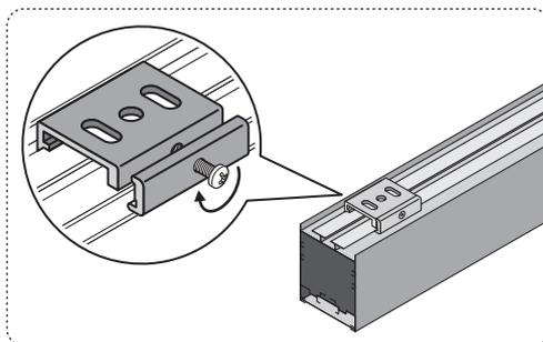
**4** Зафиксировать светильник, затянув винтом боковую площадку скоб крепления
