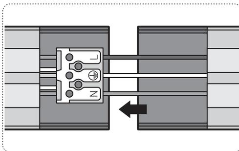
Произвести подключение следующего светильника в линии:
