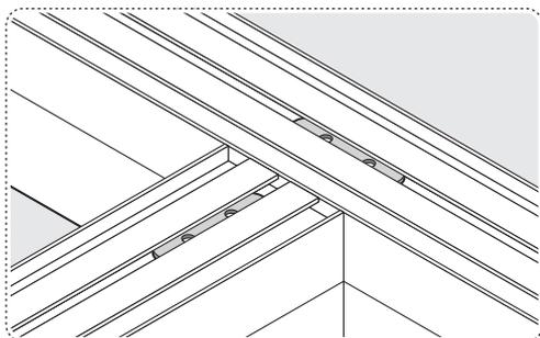
**1** Установить малые соединительные пластины в пазы соединяемых светильников
