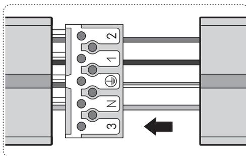
Произвести подключение следующего светильника в линии:
