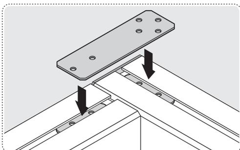
**3** Установить большую соединительную пластину
