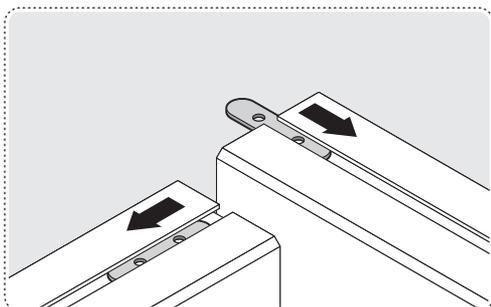
**1** Установить малые соединительные пластины в пазы соединяемых под прямым углом светильников
